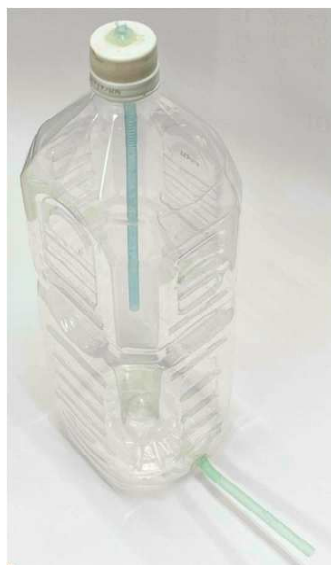
図9 マリオットの瓶の教具 ペットボトルとキャップに穴を開け、ストローをメルトーで取りつける
