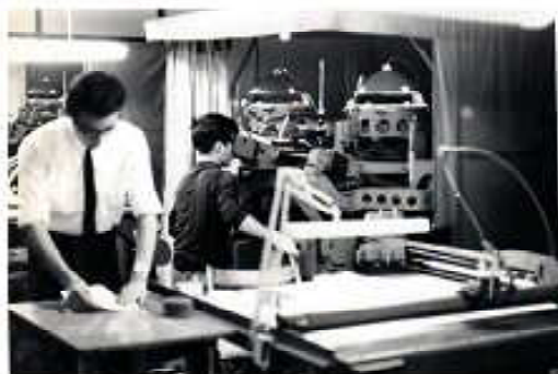
写真1 図化機による地図作成の様子*1
