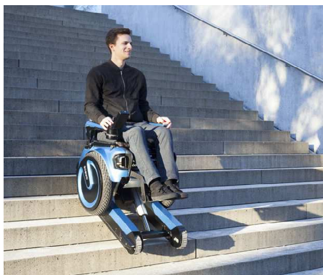
写真2 階段の上下移動が可能なScewoの電動車椅子
