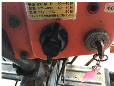
トラクタの状況は以下のようなものでした。バッテリーは13Vほど出ています。アクセルレバーを高にしないで始動したので、セルは回ったものの、失敗しました。2度目に始動させたときにはスイッチのランプが点かず、セルも回りませんでした。ヒューズを探してみましたが、よくわかりませんでした。セルモーターの入口カバーの太い線には13Vほどの電気が来ていましたが、細いコードは0Vでした。
