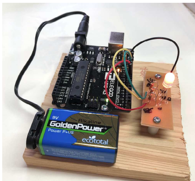
図1 製作したArduinoを利用したLEDライト
