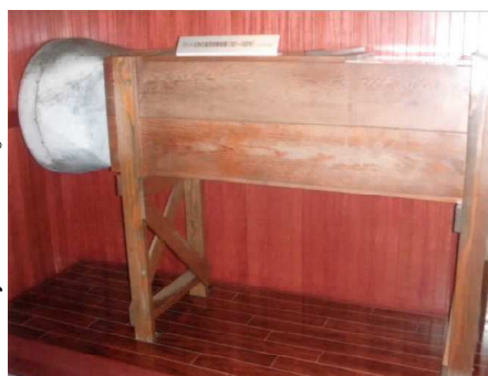
写真1 ライト兄弟の風洞実験装置(レプリカ)
