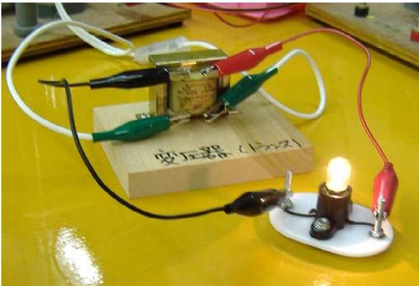
写真1 6.3V用豆電球を100V電源で点灯させる実験
