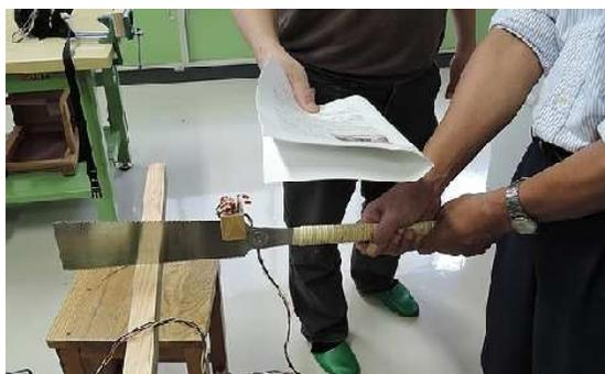
写真4 評価装置のセンサ部を隠しての実演(のこぎり上部に取りつけたセンサが反応しないように隠して切り込み始め、途中でセンサがはたらくようにする)
