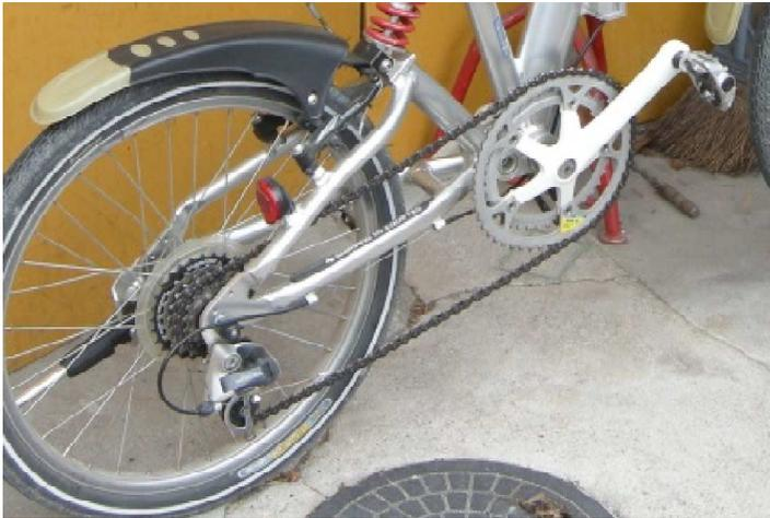
ものが消化され、「人の体力」となり、大腿部が揺動運動を、膝から足首が連接棒になり、足首から先は回転運動をする。回転運動はペダル、クランク、チェーンプロケット、チェーン、フリースプロケット、後車輪へと伝わり、自転車は前方へと移動する。と、このように動力伝達のしくみとエネルギーの変遷を学ぶよ
