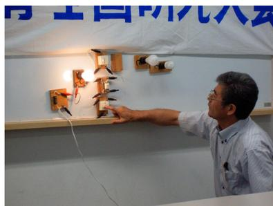
回路(2回路6接点のスイッチも使用)を生徒に考えさせる教具が電気回路説明板です。白熱電球・電球型蛍光灯・最新の LED 電球の消費電力を知るために、電流を測定し、そのちがいを目で見るのが電球のタイプ別比較板です。
