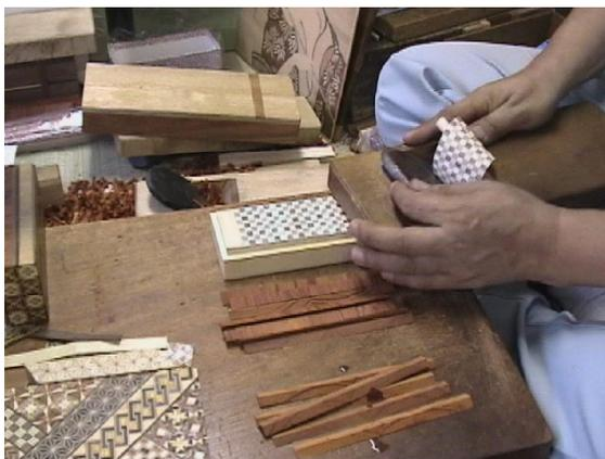
写真4 鉋で削り出される文様(箱根細工)
