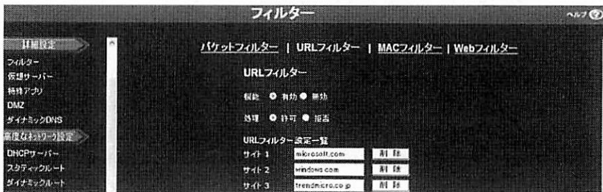
図5 特定のURLのみを通すブロードバンドルータの設定例
