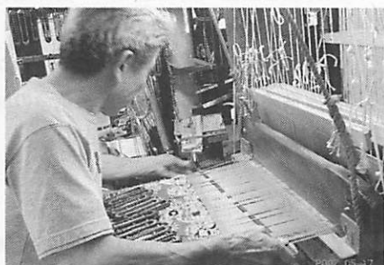
写真13 へらで金箔を引っ掛けて織り込んでいるところ (職人さんの前方に笥、その奥に綜統が見える)
