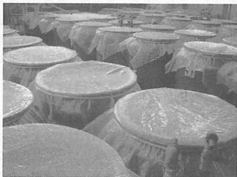
写真2 石川酒造場ではもろみの醸酵をかめ仕込みで行っている
