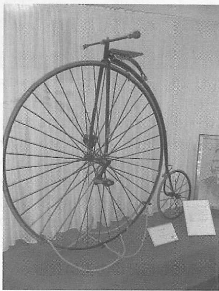
写真2：タンジェントと呼ばれるオーディナリー スポークが交差している(イギリス 1877年製)
