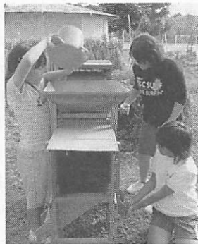
写真5 吹き出し口方向からみた唐箕
