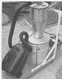
写真3 仕上がった集塵機
