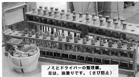
写真5 工具整理棚と油引き
