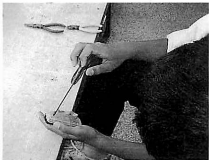
写真2 テーブルタップの組立
