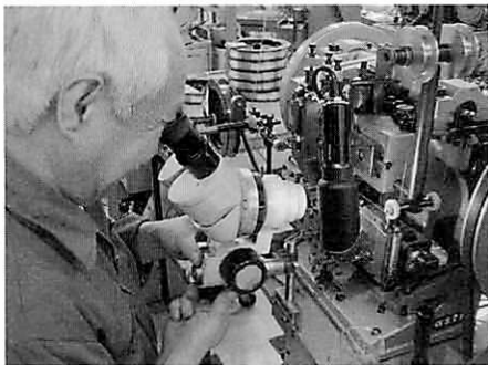
写真2 くさりを編む自動機
