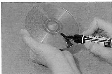
写真7 CD-ROMの読みとり面にマジックをぬる
