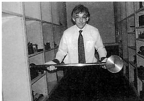
図3 ロンドン科学博物館、収蔵庫 カデュー式熱線電圧計（1883年）とキュレータ CNブラウン氏銀白金線の熱膨張を利用した120 ボルト直流交流両用
