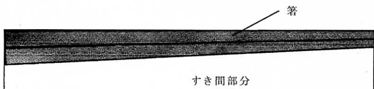
図6 すきま部分の埋め込み
