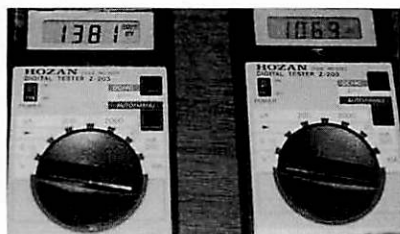
写真5 アルカリ電池（左）1381ミリボルト、マンガン電池（右）1069ミリボルトを指示
