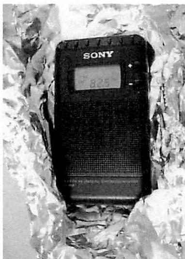
写真1(左)・2(右) 鳴っているラジオをアルミホイルで包む
