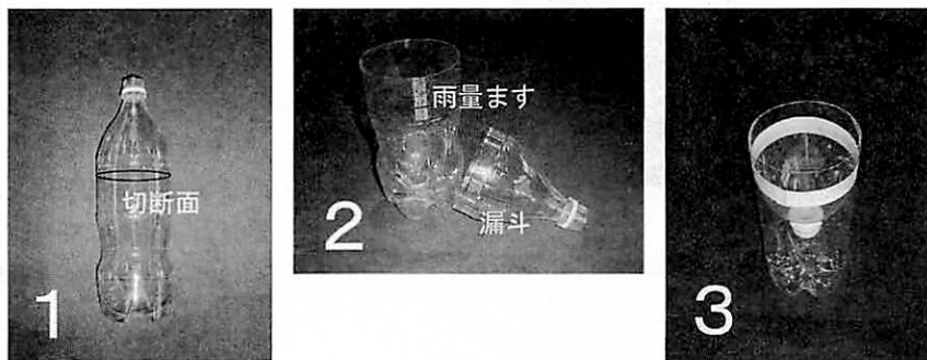
写真1 簡易雨量計の作り方
