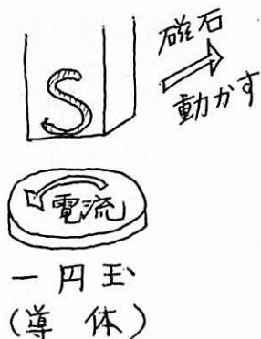
図2 磁石を動かすと一円玉に電流が流れる？
