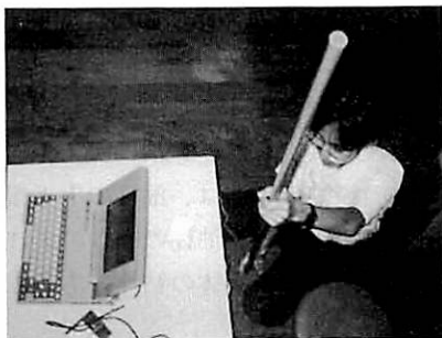
写真6 塩ビパイプの水の圧力変化の測定
