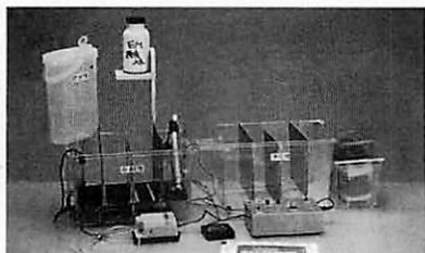
写真1 生徒が製作した家庭排水浄化装置
