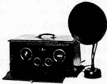
写真2 電池式真空管3球受信機(1925年製)
