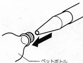
②『瞬平さん』の細い方をペットボトルに差し込み、掃除機のスイッチをオンにする。ペットボトルが潰れたら吸引を止めてキャップをしめる
