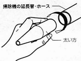
①掃除機の延長管・ホースに『瞬平さん』の太い方を差し込む
