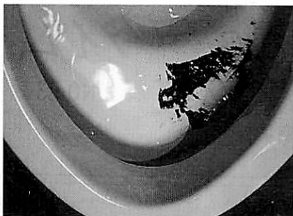
写真 中央から左側が開発技術品。水を流すだけで疑似汚物がきれいに落ちる
