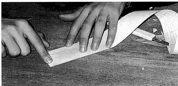
写真5 再び裏紙で押さえるようにして、かんな屑を接着する
