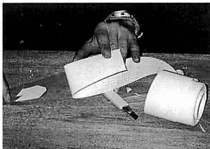
写真4 ラベルカバーの裏紙を剥がし、切り取ったかんな屑を乗せる
