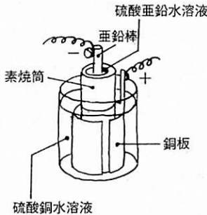
図1 ダニエル電池の構造
