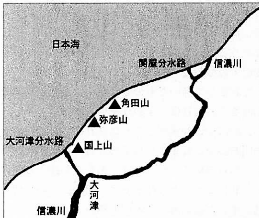
図2 信濃川下流域。日本海に沿った連山で信濃川は右へ曲がり、大河津からは勾配も急に緩くなる。これが原因となり大きな氾濫が絶えなかった。大河津分水路は、この原因を取り除く大きな役割を果たしている。
