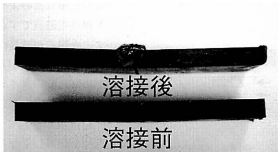
写真2 溶接された上側へ反り上がる板材 残留応力発生源の一つです。
