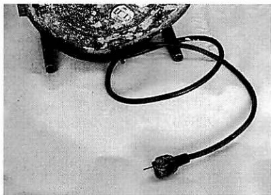
写真3 プラグの片方の刃が折れる
