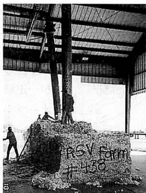
写真8 現代のジン工場 (原綿の吸引作業)
