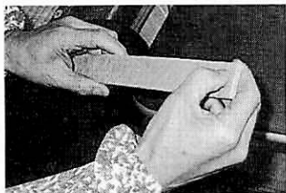
写真4 ローラーに用いる牛革
