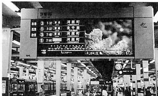
写真2 プラスチック光ファイバー168万本を使用した「レイテラビジョン」の応用例
