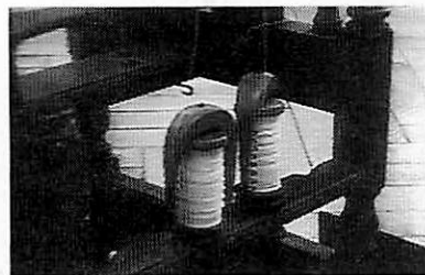
写真7 ポビンとフライヤー部 (2 錘は欠落)
