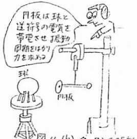
図11(b) クーロンの振動周期による引力の実験
