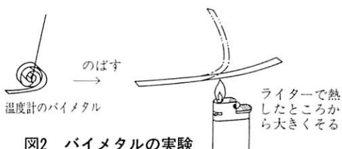
図2 バイメタルの実験
