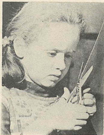
写真1 直線切断のさい、けがき線の外側にそって切断、はさみは先端まで切り閉じない。
