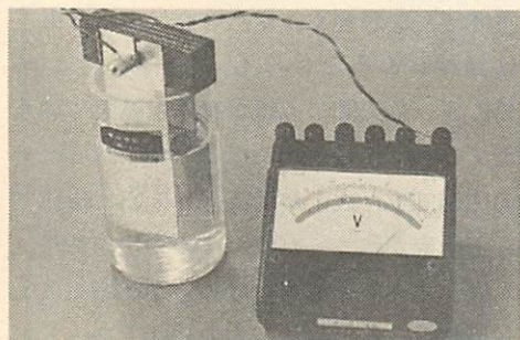
起電力が生じていることの確認
