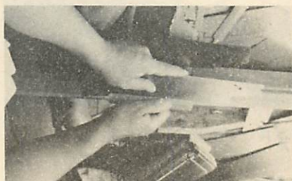
写真11 最後に刃の側面をならす
