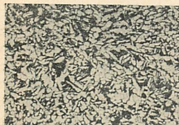
再結晶温度以下（1000°C）加熱，鍛錬組織 ×150
